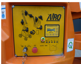
AIRO A12 JE, SG 224134-Bodensteuerung
