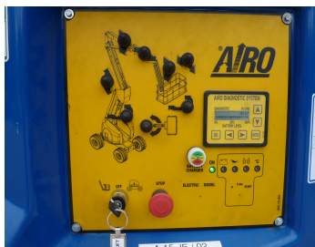
AIRO A15 JE, SG224245-Bodensteuerung
