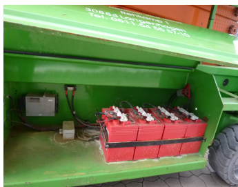
HAB S125-16 E2WD, SN 221401014-Batterieantrieb
