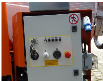
Multitel SMX 170-Bodensteuerung
